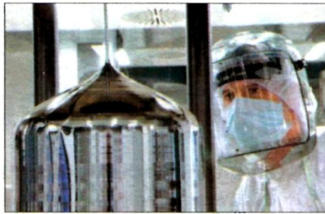
Vorstufe der Wafer (Grundplatten): Das Silizium, das erzeugt wird, wenn Polysilizium geschmolzen und in einem Ofen kristallisiert wird, nennt sich Ingot. Dieses zylindrische Stück wird später in 0,18 bis 0,28 mm dicke Scheiben, die Wafer, gesägt.
