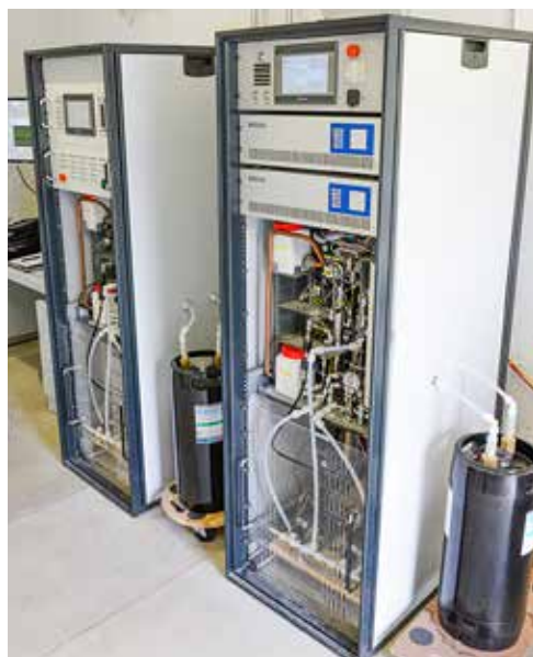
Zwei jeweils 10-kW große Elektrolyseure produzieren bei GP Joule seit Ende letzten Jahres Wasserstoff aus grünem Strom. Foto: Dierk Jensen
