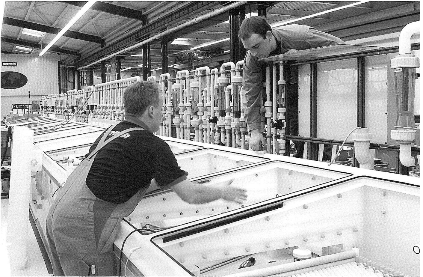
TEAMWORK: Arbeiter bauen einzelne Säurebäder für die Zellen-Reinigung zusammen.
